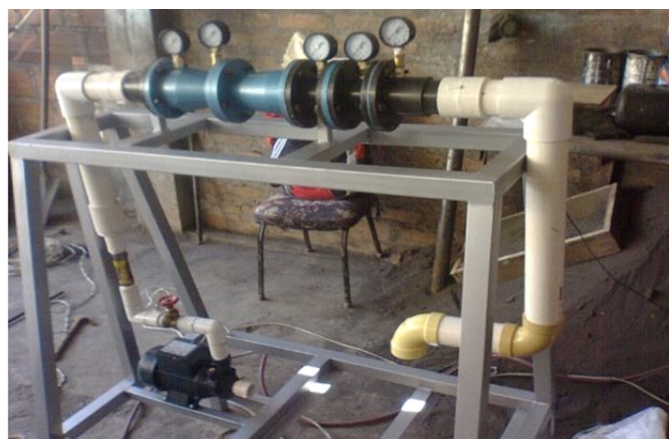
Figura 5. Sistema medidor de flujo
