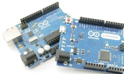
Figura 2. Arduino UNO y Arduino Leonardo (Monk, 2013).
