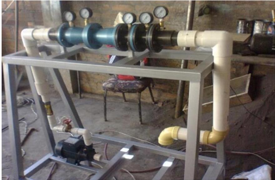
**Figura 5.- Sistema medidor de flujo.**
