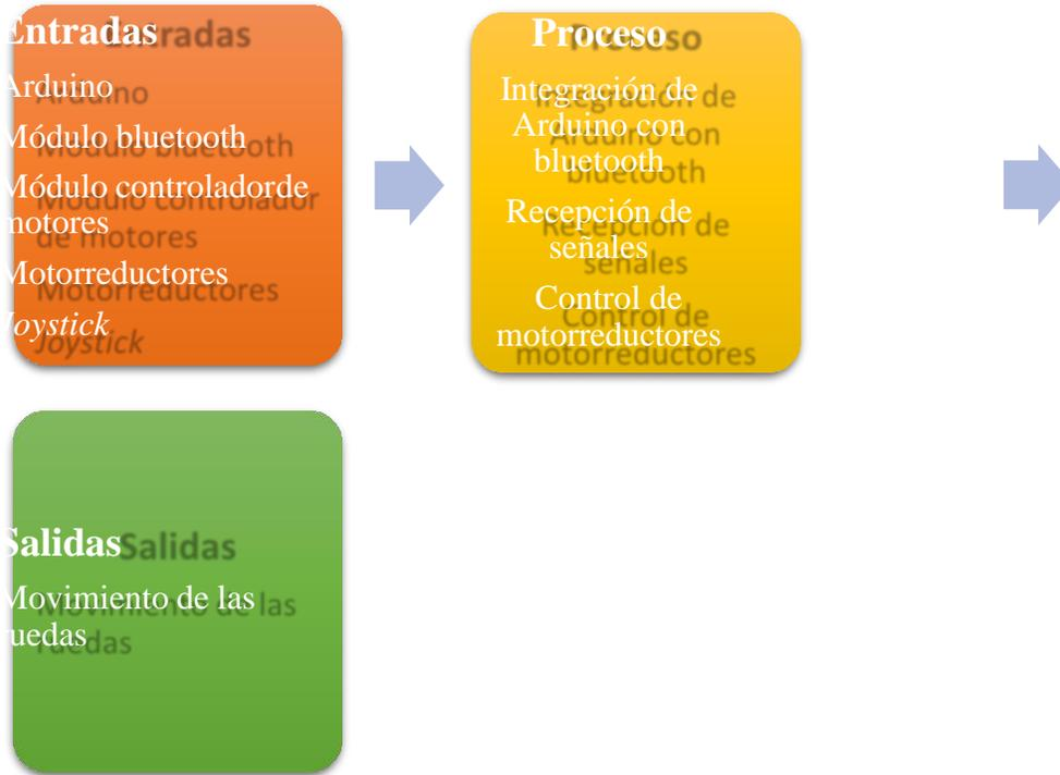
Figura 14. Diagrama descriptivo del funcionamiento del prototipo (elaboración propia).
