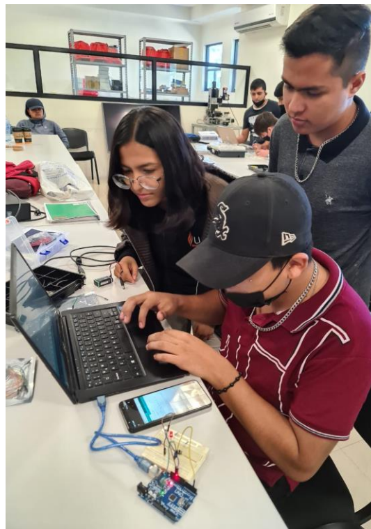
Figura 8. Ejemplo de resultado de práctica 6. Grupo de alumnos trabajando en equipo en el diseño de un circuito para encender/apagar un led mediante un botón pulsador utilizando Arduino Uno.
