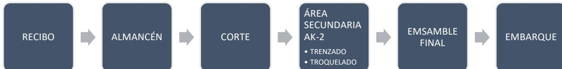
Figura 1. Proceso de fabricación del arnés.
