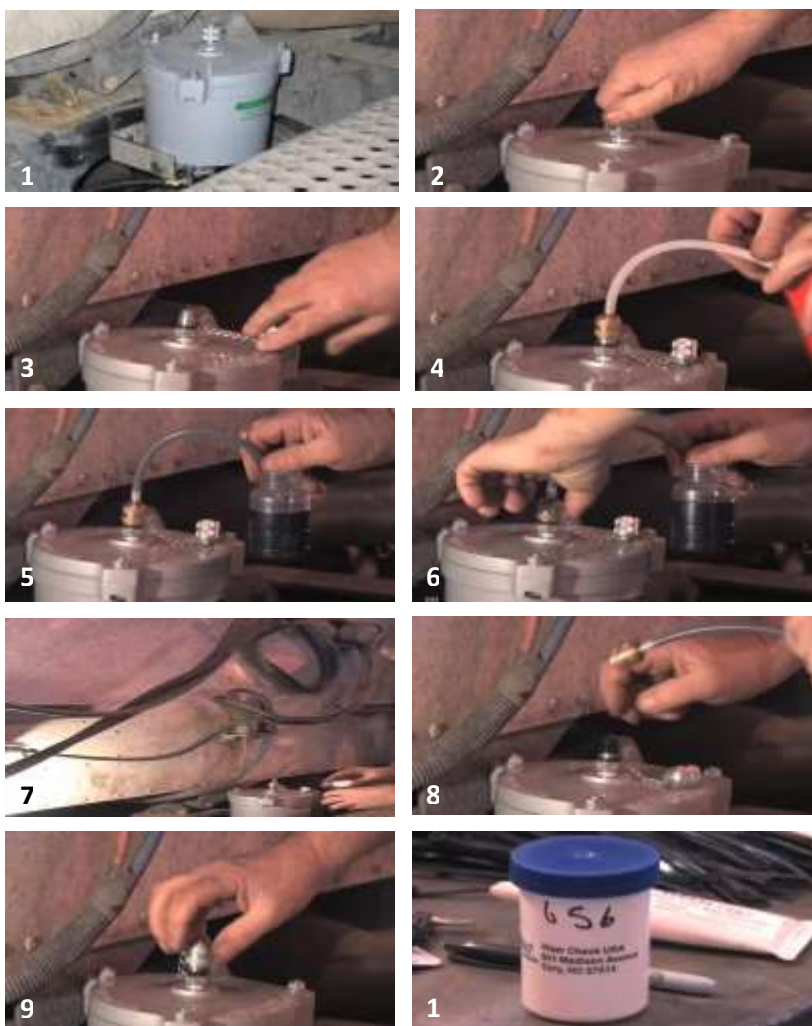
Figura 6. Pasos a seguir para la obtención de la muestra de aceite.
